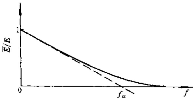
图 6.4 归一化刚度随裂纹密度的变化曲线
