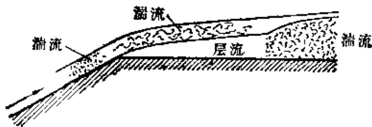
图 17.6 超声速绕拐角流动边界层中的流动示意图,根据 J. Sternberg,参见图 17.5
