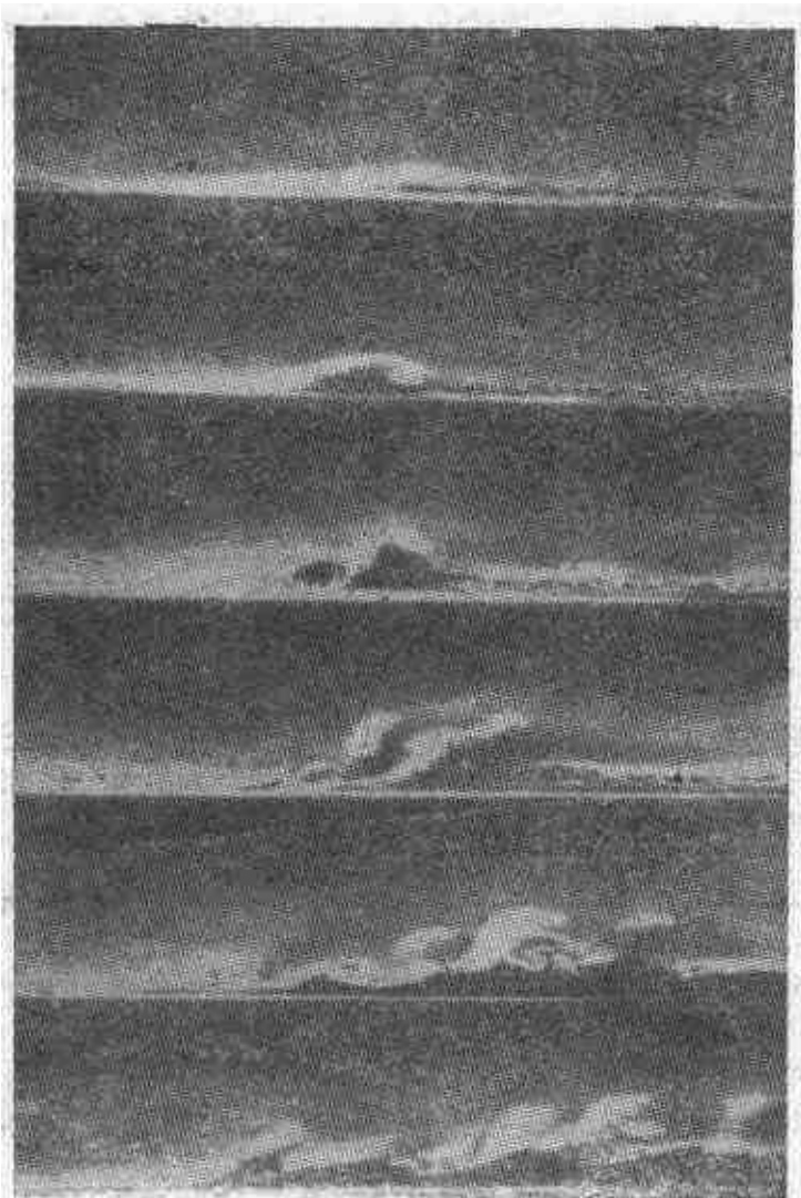
图 16.15 沿平板的流动。湍流起源于长波长的扰动,引自 L. Prandtl [60] 这些照片是利用低速电影摄影机拍摄的,将摄影机装在沿流动方向运动的小车上,因此,摄影机一直对准同一群旋涡。将铝粉撒在水面上来显示流动
