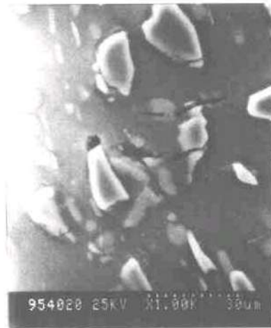
图 3.1 一种复合材料在承载过程中出现的微损伤
